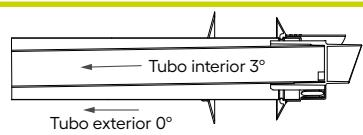
Los KITS se fabrican con el tubo interior a una inclinación de 3º.
